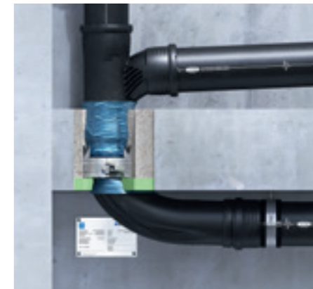
In der Decke eingelassenes Geberit Rohrschott90 Plus EN mit notwendiger EPS/XPS Dämmung für minimalen Deckenabstand.
