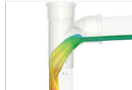
Mit der numerischen Strömungssimulation CFD (Computational Fluid Dynamics) können Varianten vorab virtuell getestet werden...
