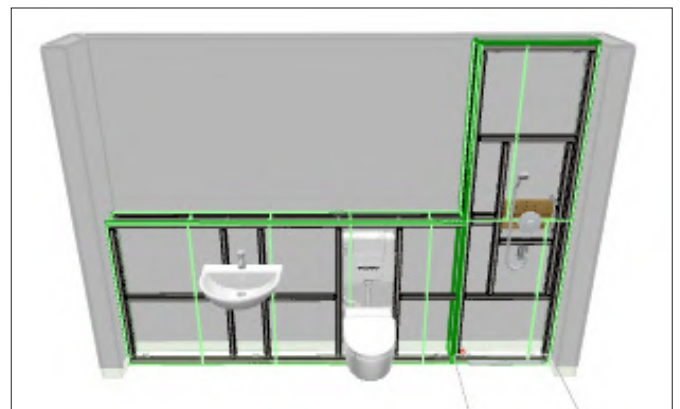
Abbildung 28: 3D-Ansicht einer fertig geplanten Installationswand
