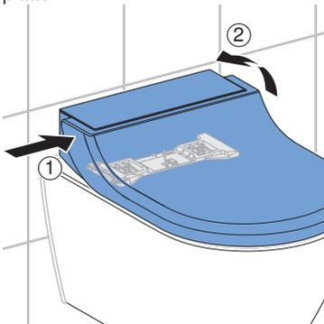
**3** Heben Sie das Gerät an, soweit es der Abnehmebegrenzer zulässt. Reinigen Sie den Zwischenraum zwischen Dusch-WC und WC-Keramik.
