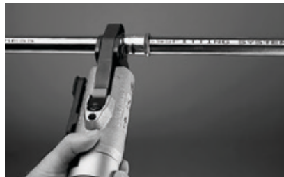
Abbildung 38: Pressvorgang mit Pressbacke d 12 - 35 mm
