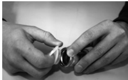
Abbildung 25: Schutzkappe entfernen, Dichtring prüfen
