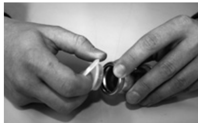
Abbildung 36: Schutzkappe entfernen, Dichtring prüfen
