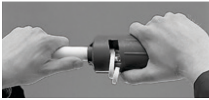
Abbildung 32: Abmanteln des Kunststoffmantels auf Einschubtiefe
