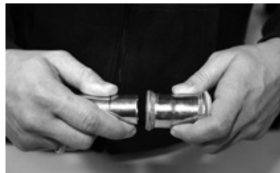
Abbildung 26: Ineinanderschieben von Systemrohr und Pressfitting
