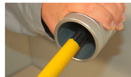
Bild 11: Innenentgraten mit Handentgrater
