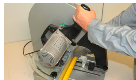
Bild 5: Ablängen mit mechanischer Säge mit Elektromotor
