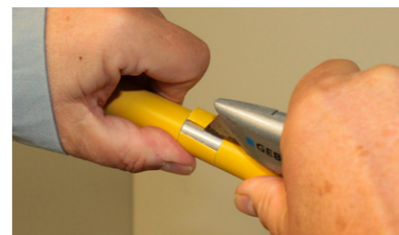
Bild 8: Schlitzen des Kunststoffmantels
