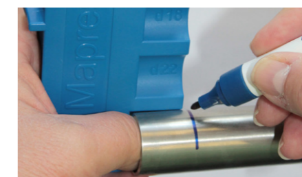
Bild 14: Markieren der Einschubtiefe mit Einschubtiefenlehre
